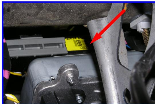
**SEGNALATORE ACUSTICO:** Posizionare il buzzer sul fianco della ECU abitacolo, zona fusibili lato guida. Per il fissaggio pulire accuratamente la superficie con alcool quindi utilizzare il velcro in dotazione.
